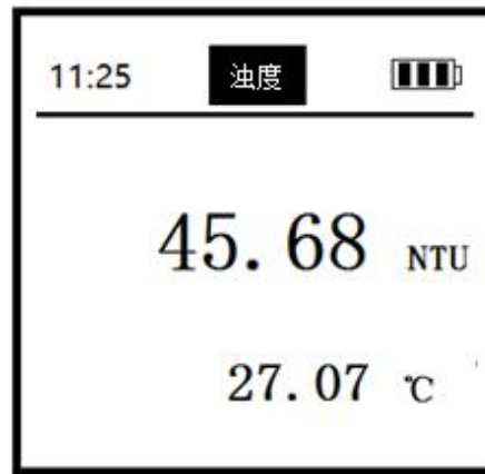
浊度界面：包括浊度 NTU 和温度°C。
