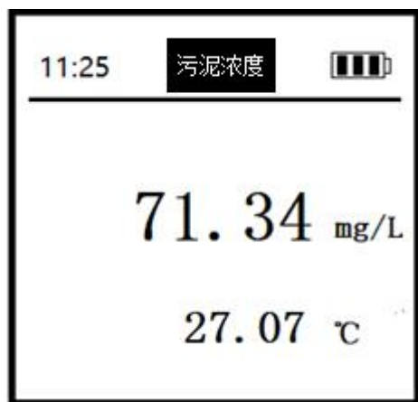
污泥浓度界面：包括污泥浓度 mg/L 和温度°C。
