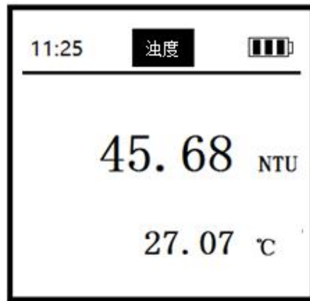
浊度界面：包括浊度 NTU 和温度°C。
