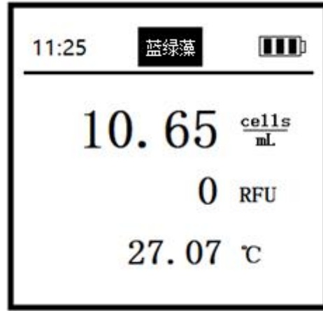
蓝绿藻界面：包括蓝绿藻 cells/mL，RFU(相对荧光单位)和温度°C。
