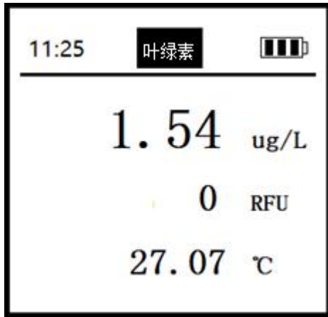
叶绿素界面：包括叶绿素 ug/L，RFU(相对荧光单位)和温度°C。
